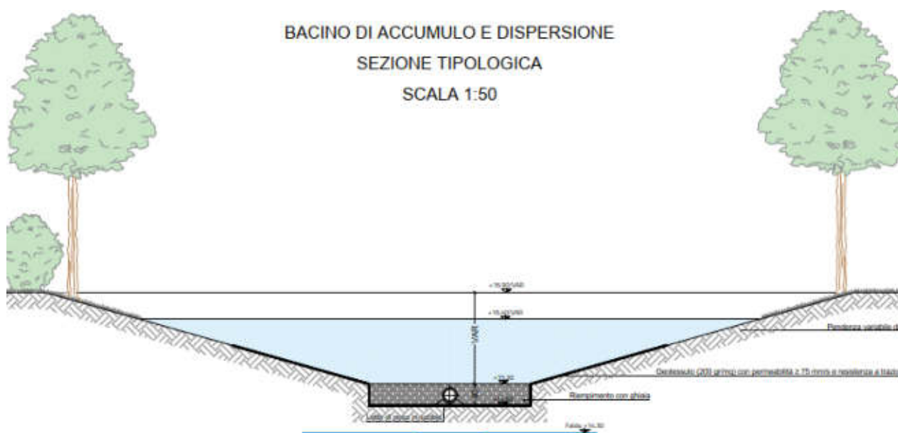
Figura 9 – Sezione tipo vasche disperdenti
