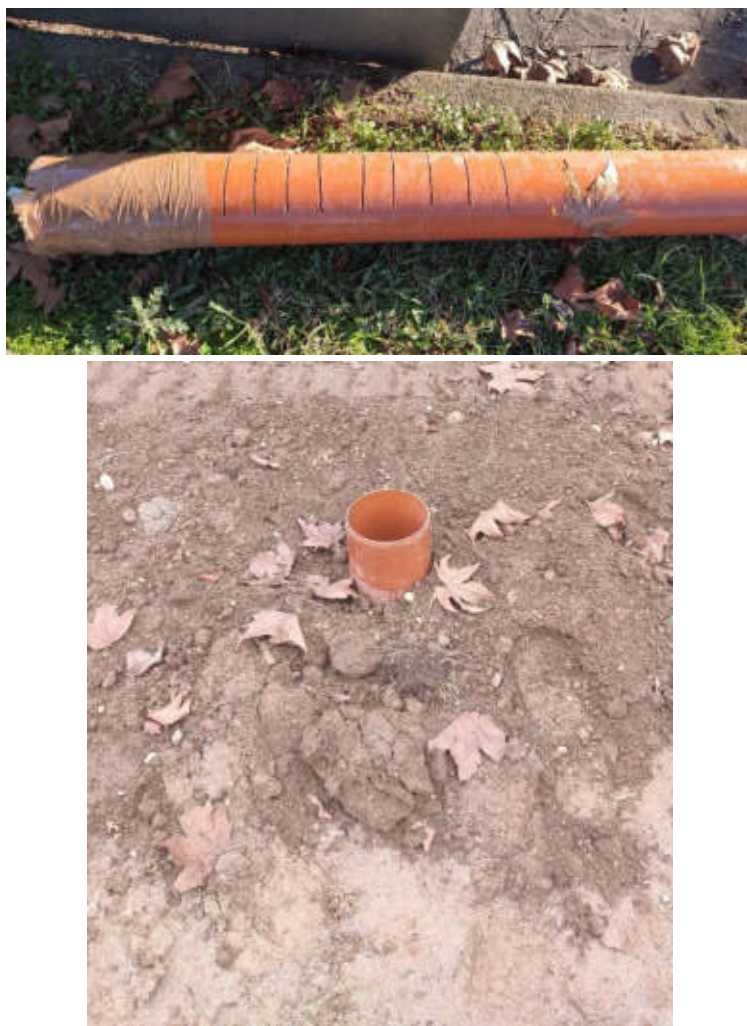
Figura 4 – Attrezzatura per la prova di permeabilità in situ
